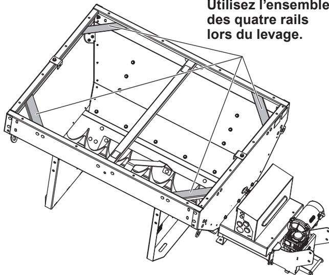
4. Centrer l'épandeur d'un côté à l'autre. Déplacez l'épandeur vers l'avant ou l'arrière jusqu'à une position qui permettra à la goulotte, une fois installée, de surplomber l'arrière du véhicule et le pare-chocs. Avec deux autres personnes, essayez de monter la goulotte pour vérifier le dégagement.
