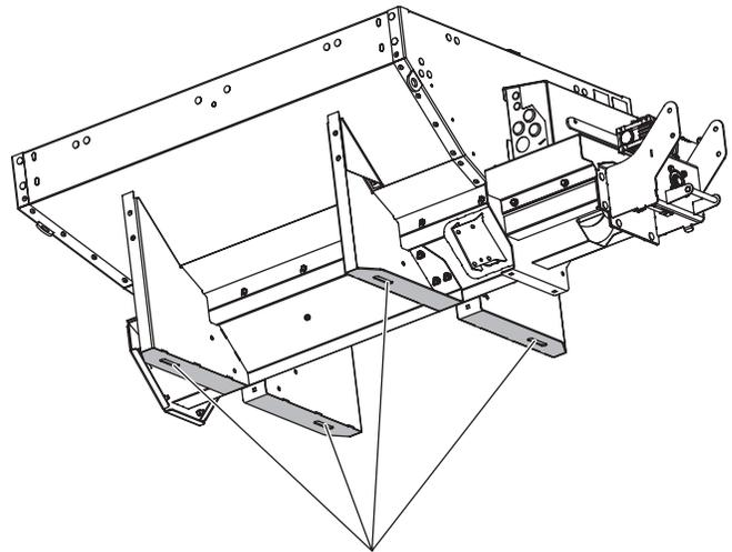
**REMARQUE :** Faites particulièrement attention lorsque vous percez ou fixez des métaux dissemblables sur des carrosseries en aluminium. Une corrosion galvanique peut survenir en cas de mauvaise manipulation. Contactez le fabricant du véhicule pour connaître les pratiques d'attache recommandées.
