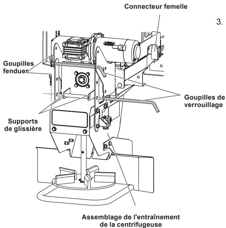
2. Fixez l'ensemble d'entraînement de la centrifugeuse à l'épandeur à l'aide des goupilles de verrouillage de la boîte de pièces. *Installez d'abord la goupille de verrouillage supérieure.*
